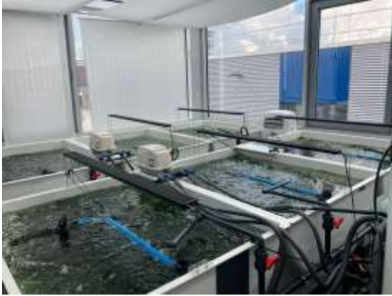
1: Deniz yosunu yetiştiriciliği için tamamlanan büyük ölçekli geri döngülü su ürünleri yetiştirme sistemi, TRL6-7 aşamasında. İnşaat Mart ayında tamamlandı ve Nisan ayında Ulva spp. ile inoküle edildi, bu yosunlar raf birimizden temin edilmiştir
